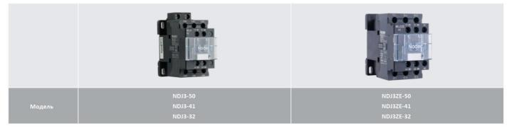
Первая цифра в указании модификации – количество НО контактов, вторая цифра – количество НЗ контактов. Номинальный рабочий ток le(A): AC-15 400V 2.4A, DC-13 250V 0.3A
