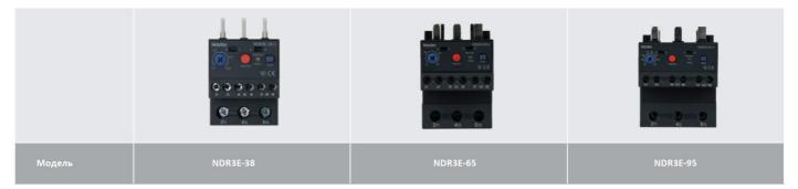
В серии NDR3E представлены аппараты электронного типа с диапазоном защиты от 0.1A до 40A(для NDR3E-38), от 20 до 80A(для NDR3E-65) и от 40A до 110A(для NDR3E-95), класс расцепления 10/20. Совместимы с контакторами серии NDC3. Номинальное рабочее напряжение: до AC690V.
