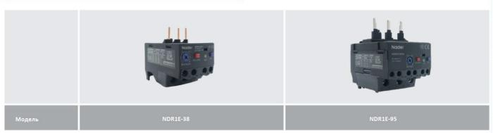
В серии NDR1E представлены аппараты электронного типа с диапазоном защиты от 0.1А до 40А(для NDR1E-38) и от 30А до 95А(для NDR1E-95), класс расцепления 10 и 20. Совместимы с контакторами серии NDC1. Номинальное рабочее напряжение: AC220/230V, AC380V/400V, AC415V, AC660/690V.
