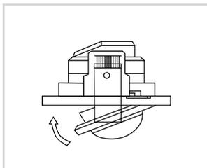
Датчик ДДТ-03 благодаря поворотному механизму может регулироваться без проведения демонтажа из потолка.
