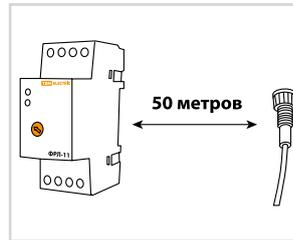
Вынесение фотодатчика от фотореле позволяет установить датчик в любом удобном месте, а само фотореле – в щитке, чтобы собрать схему управления любой сложности.
