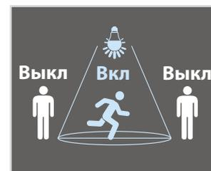
Позволяет экономить электроэнергию благодаря наличию встроенных датчиков – микроволнового датчика движения и датчика освещенности.
