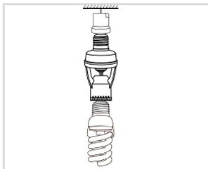
Датчик ДДПт-01 не требует дополнительных электрических подключений и устанавливается непосредственно в патрон E27.
