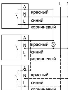
**Схема с добавлением настенного выключателя в цепь для ручного подключения нагрузки**
