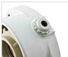
Корпус светильника выполнен из глазурированной керамики, что обеспечивает повышенную прочность, водо- и газонепроницаемость корпуса, а также простоту в обслуживании.
