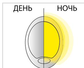
Датчик освещенности (в зависимости от модели): светильник включается с наступлением темноты и при недостаточном освещении.
