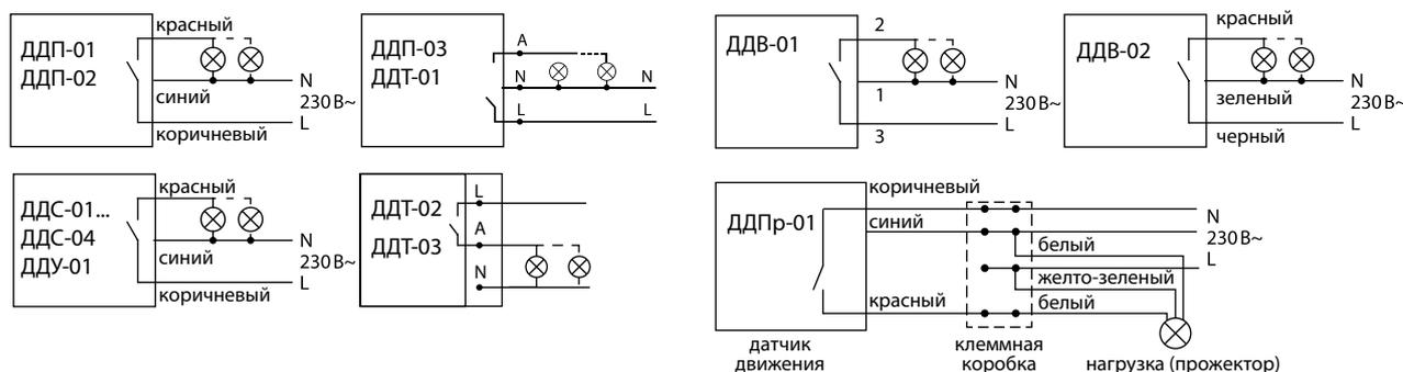
**Электрические схемы подключения**
