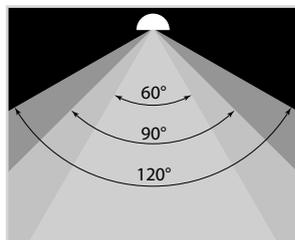
3 модели алюминиевых отражателей с углом рассеивания 60°, 90° и 120°, одинаково подходящие для всех мощностей светильников.
