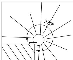
Датчик ДДУ-01 устанавливается на внешний угол стены и имеет угол обзора 270°.
