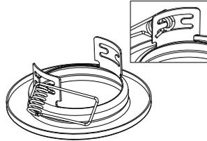
**1.** Вынуть фиксатор лапки из пружины. Завести в отверстие упор пружины, как показано на рисунке.
