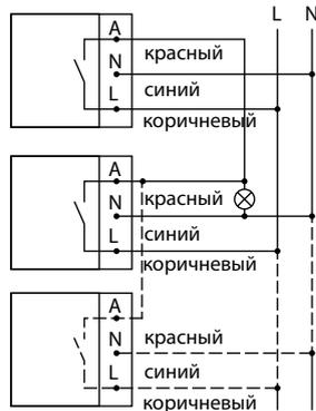
**Схема с добавлением настенного выключателя в цепь для ручного подключения нагрузки**
