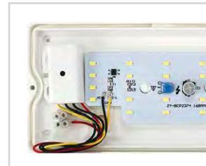
Светильник оснащен светоаккустическим датчиком (САВ) (арт. SQ0353-0202) или микроволновым датчиком движения (МДД) (арт. SQ0353-0203) с помощью которых производится автоматическое включение-выключение освещения для экономии электроэнергии.
