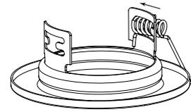
**2.** Надеть пружину на уши, сжав лапку пружины в направлении указанном стрелкой.
