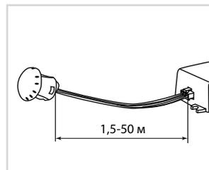
Длина провода от корпуса до выносного датчика – 1,5 метра, при необходимости ее можно увеличить до 50 метров, используя любой трехжильный провод.
