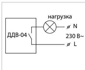
Датчик ДДВ-04 работает с разными типами ламп (накаливания, светодиодные, люминесцентные), при этом для его питания не требуется проведения нулевого проводника в монтажную коробку.
