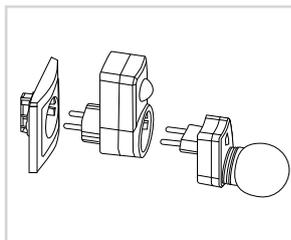
Датчик ДДР-01 подключается в розетку 230 В, что позволяет включать любое однофазное электрооборудование при обнаружении движения.
