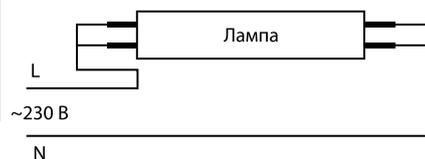
**Внимание! В светильниках следует применять светодиодные лампы с двухсторонним подключением (см. схему).**
