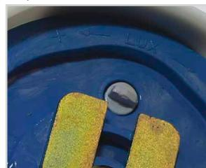
В моделях ФРЛ-02 и ФРЛ-03 предусмотрена возможность регулировки порога срабатывания от 5 до 50 лк.
