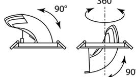
Направление свечения регулируется поворотом корпуса светильника до 360° по горизонтали и наклоном до 90° по вертикали.
