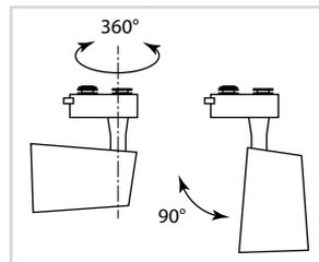
Направление свечения регулируется поворотом корпуса светильника до 360° по горизонтали и наклоном до 90° по вертикали.
