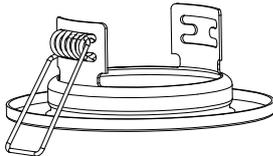
**3.** Установить фиксатор лапки внутрь пружины. Повторить те же действия со второй пружиной.
