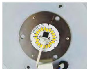
Светодиодная матрица прямого включения в сеть 230 В (источник питания постоянного тока встроен в плату).
