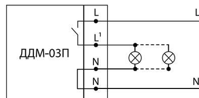
**Пример подключения двух и более датчиков движения к общей нагрузке**
