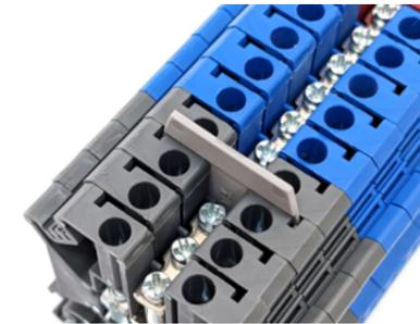
Изоляционная пластина служит для электрического и визуального разделения соседних перемычек. Она необходима, чтобы клеммы могли выдерживать полное номинальное напряжение с обеих сторон перемычки.
