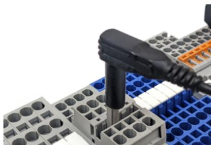
— Благодаря небольшому внешнему диаметру тестового адаптера можно использовать защитные штекеры, которые не допускают прикосновения к токоведущим частям.
