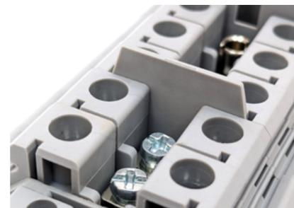
Изоляционная пластина служит для электрического и визуального разделения соседних перемычек. Она необходима, чтобы клеммы могли выдерживать полное номинальное напряжение с обеих сторон перемычки.
