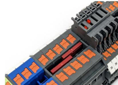
Два ряда шунтирования обеспечивают возможность подключения любого количества клемм с помощью перемычек. Используя перемычки можно соединить за один раз до 10 клемм.
