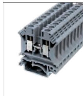
RUK 6N Клемма универсальная Ширина 8.2мм / 57A / 6мм 2 Стр. 043
