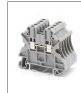
RUT 2,5 Клемма универсальная Ширина 5.2мм / 24А / 2.5мм 2 Стр. 027
