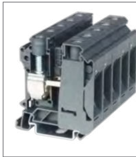
RTB 35 Клемма проходная Ширина 15.2мм / 125А / 35мм 2 Стр. 090
