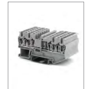
RNS 2,5-QUATTRO Клемма пружинная, 4 контакта Ширина 5.2мм / 24А / 2.5мм 2 Стр. 106
