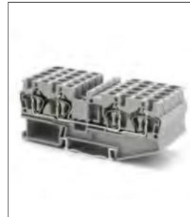
RNS 4-QUATTRO Клемма пружинная, 4 контакта Ширина 6.2мм / 32А / 4мм 2 Стр. 107
