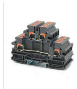
RPITT 4 Клемма Push-in, 2 уровня Ширина 6.2мм / 32А / 4мм 2 Стр. 005
