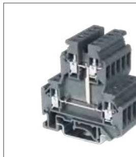
RTB 4-L/LB-PV Клемма 2 уровня Ширина 6.2мм / 32А / 4мм 2 Стр. 096
