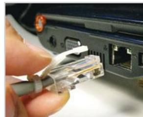
Надежность соединения разъема за счет фиксации в гнезде.
