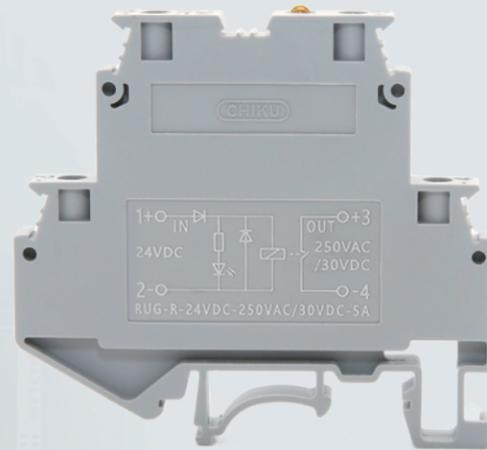
Эти устройства состоят из основной клеммы для монтажной рейки с винтовым зажимом, печатной платы с небольшим реле с контактами и периферийными электронными компонентами. Применяются для организации интерфейса ввода-вывода в системах промышленного управления, а также в качестве выходных реле. Позволяют увеличить количество контактов в контурах защиты и управления.
